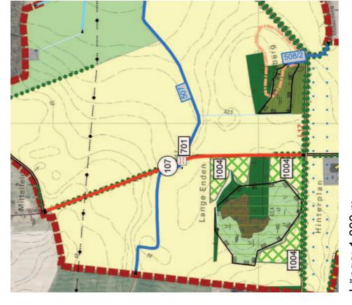
Länge: 1.000 m Ausbaubreite: 3,0 m Ausbauart: Spurbahn Beton
