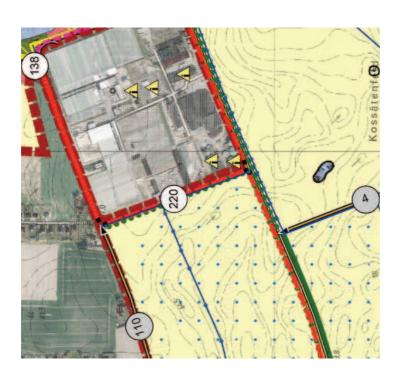
Länge: 420 m Ausbaubreite: 2,0 m Ausbauart: Asphalt
