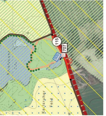
Länge: 395 m Ausbaubreite: 3,0 m Ausbauart: Asphalt
