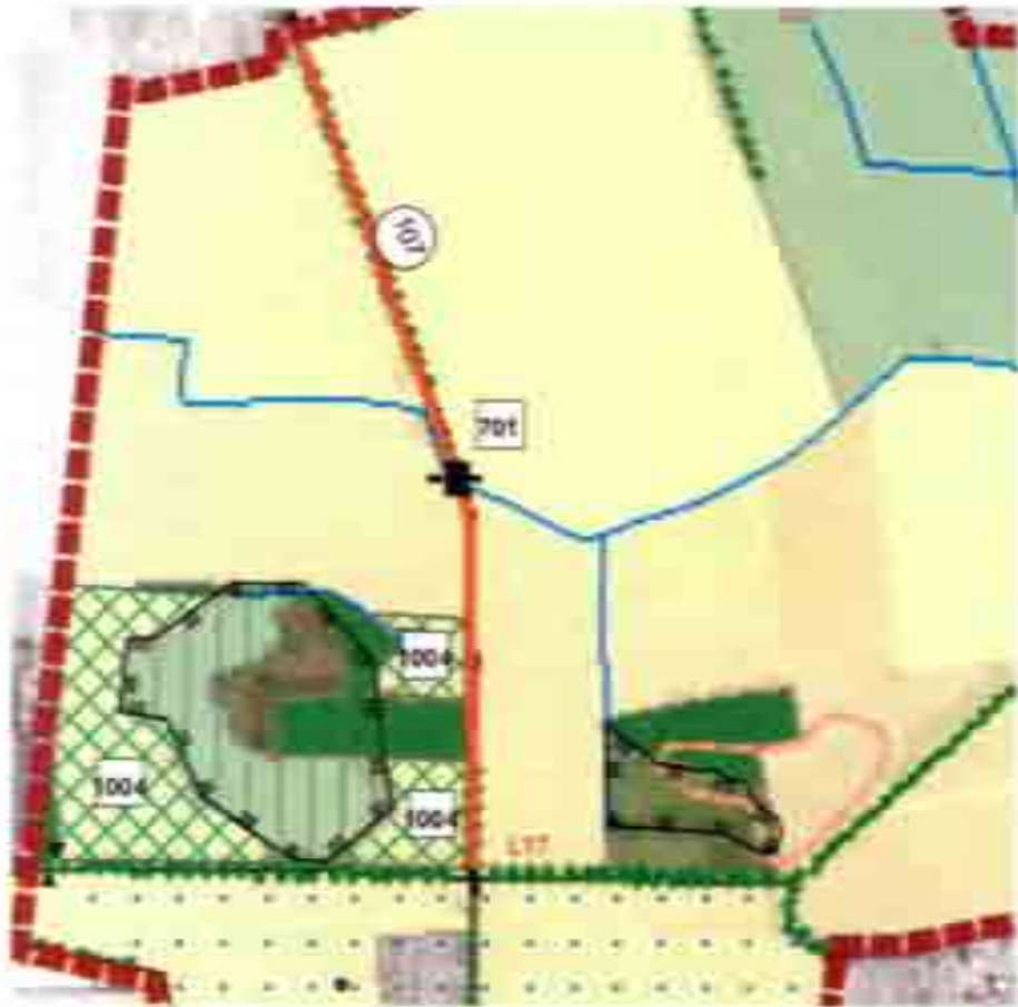
Weg 107: Länge: 1.025 m, Ausbauart: Spurbahn Beton
