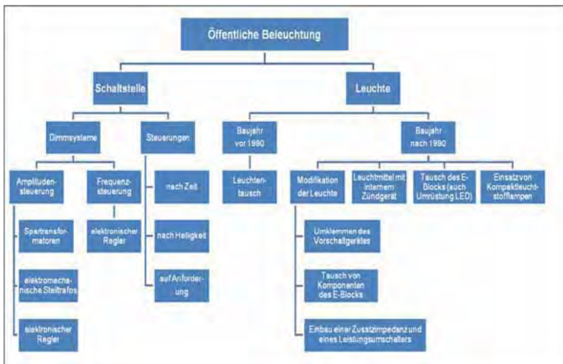
Abbildung 29: Übersicht über die prinzipiellen Möglichkeiten zur Energieverbrauchsoptimierung
