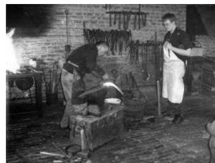
Aus einer größeren Eisenstange entsteht danach eine Zaunstrebe. Diese wurden in früheren Jahren in großer Stückzahl in Handarbeit von Schmieden gefertigt.
